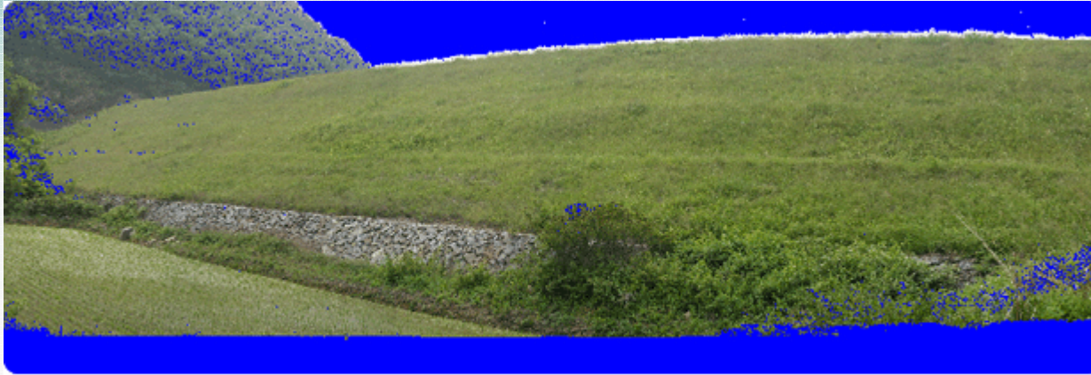
Point Cloud 데이터에 고해상도 디지털 카메라로 촬영한 이미지 데이터를 획득한 모습. 자료상 파란색상 부분은 스캔 데이터가 없는 부분임
